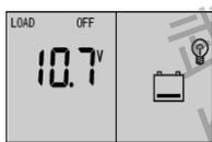
如左图所示，显示的数值为欠压保护电压。当蓄电池电压低于此数值系统将断开负载，防止蓄电池被过度放电。在此界面可使用▼/▲键调整该参数且参数开始闪动。长按■键（>5秒），保存该参数，数字停止闪动则保存成功，短按■按键，则放弃该数值保存，且进入下一界面。
