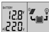
系统初始上电 LCD 屏显示内容如右图所示, 信息由充电状态、电池电量状态、负载状态、电池电压, 交流输出电压、风机状态及市电补充状态等。在此界面可按
