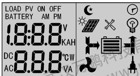
LCD 屏信息显示分左侧参数显示和右侧状态显示
