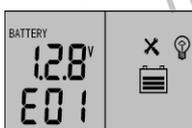
屏幕显示如右图所示并闪动表示负载回路出现短路故障，控制器已进入短路保护状态。检查负载是否损坏，负载连接线是否短路，排除故障后短按▼/▲键恢复。
