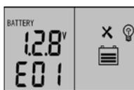
屏幕显示如右图所示并闪动表示负载回路出现短路故障，控制器已进入短路保护状态。检查负载是否损坏，负载连接线是否短路，排除故障后短按  $\nabla/\blacktriangle$  键恢复。
