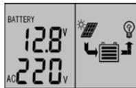
系统初始上电 LCD 屏显示内容如右图所示，信息由充电状态、电池电量状态、负载状态、电池电压，交流输出电压、风机状态及市电补充状态等。在此界面可按 **▼/▲** 键 控制负载的开或关状态。
