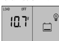
如左图所示，显示的数值为欠压保护电压。当蓄电池电压低于此数值系统将断开负载，防止蓄电池被过度放电。在此界面可使用 **▼/▲** 键调整该参数且参数开始闪动。长按 **■** 键 (>5 秒)，保存该参数，数字停止闪动则保存成功，短按 **■** 按键，则放弃该数值保存，且进入下一界面。
