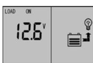
如左图所示，显示的数值为欠压恢复电压。在控制器欠压保护后，蓄电池电压恢复到高于此数值时，控制器将重新接通负载回路。在此界面可使用 **▼/▲** 键调整该参数且参数开始闪动。长按 **■** 键 (>5 秒)，保存该参数，数字停止闪动则保存成功，短按 **■** 按键，则放弃该数值保存，且进入下一界面。
