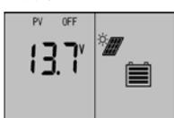
如左图所示，显示的数值为停充电压。在蓄电池电压达到停充电压时，控制器将断开充电回路，防止蓄电池被过度充电。在蓄电池电压下降后将重新接通充电回路。在此界面可使用 **▼/▲** 键调整该参数且参数开始闪动，长按 **■** (>5 秒)，保存该参数，数字停止闪动，短按 **■** 按键，则放弃该数值保存，且进入下一界面。
